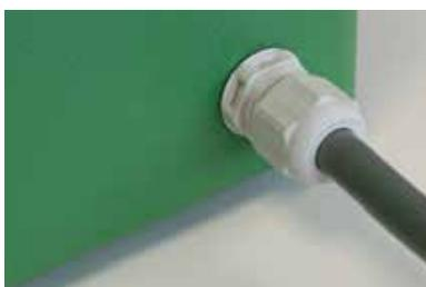
Le passe-câble fourni est utilisable pour un câble bipolaire d'un diamètre extérieur de 10mm. Assurez-vous que le passe-câble est suffisamment serré. Cela agit également comme un dispositif de réduction de tension.
